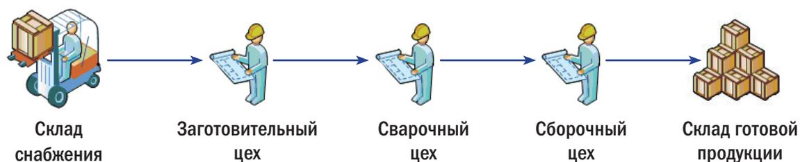
**Рис. 1.** Производственная цепочка предприятия по выпуску металлоконструкций.
